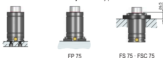
Posibilidades de montaje · Assembly possibilities
