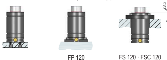
Posibilidades de montaje · Assembly possibilities
