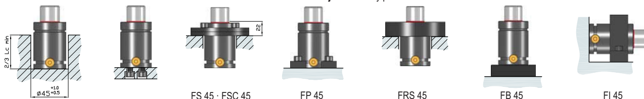
Posibilidades de montaje · Assembly possibilities
