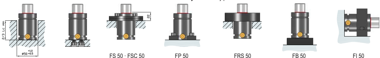
Posibilidades de montaje · Assembly possibilities
